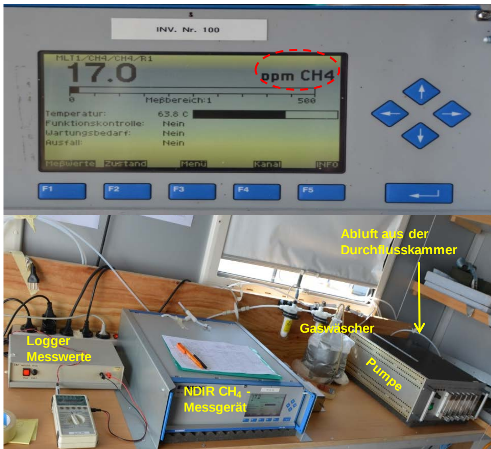
Abbildung 11: Messgeräteaufbau im Innern des Messwagens
