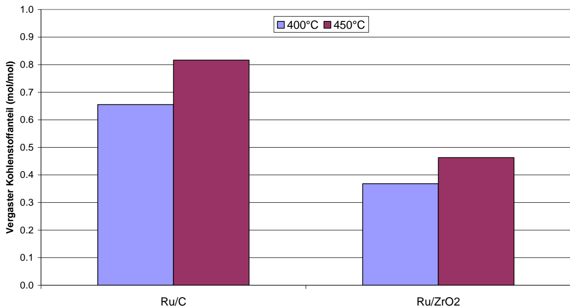
Abb. 8: Vergleich der Kohlenstoffvergasung von Ru/C und Ru/ZrO 2 bei 400°C und 450°C und sonst identischen Bedingungen (Feed-TS = 16.1%, Ru/S = 5.5, t = 60 min.).
