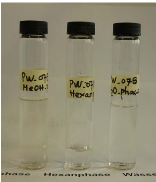
Abb. 6: Methanol-, Hexan- und Wasserphase des Vergasungsversuchs PW-07B mit dem Ru/C-Katalysator ( GE_C = 82\% ).
