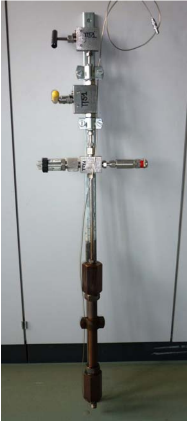
Abb. 2: Foto des Batchreaktors. Der dunkle, untere Teil wird jeweils in ein fluidisiertes Sandbad eingetaucht. Gesamte Höhe ca. 1 m.
