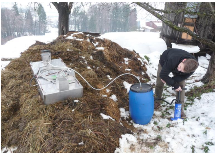
Abbildung 4: Probenahme mittels belüfteter Probenahmehaube und 1 Minuten Probenehmer
