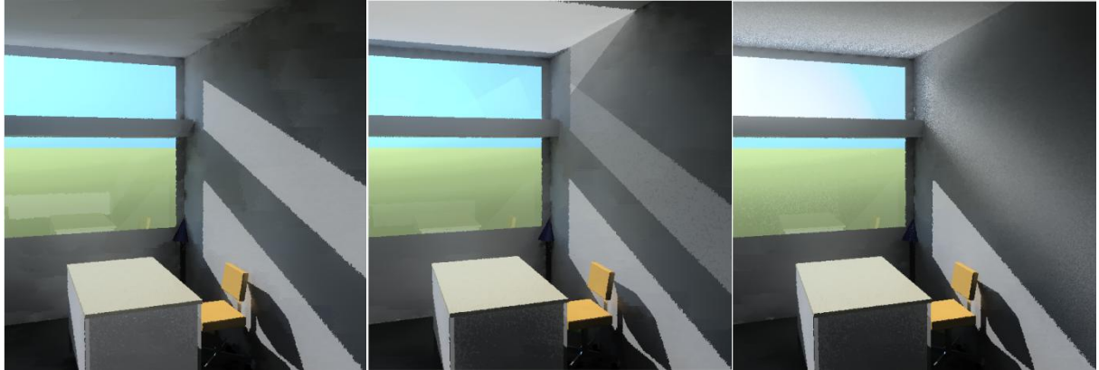
Figure 5.9 : Visualisation d'un système complexe de fenêtres de type Laser cut panel ; de gauche à droite : fenêtre supérieure munie d'un double vitrage ( glass ), simulation par la fonction BTDF2prism2 et simulation par la fonction mkillum et le matériau bsdf .
