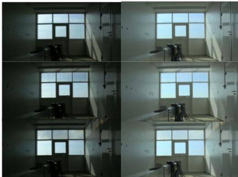
Figure 2.2 : Vues intérieures des modules en éclairage naturel DEMONA munis de différents systèmes complexes de fenêtres sur la partie supérieure de la façade : (haut) vitrage isolant standard, (centre) laser cut panel et (bas) 3M SOLF prismatic film; les images gauche et droite diffèrent par leur temps d'exposition.
