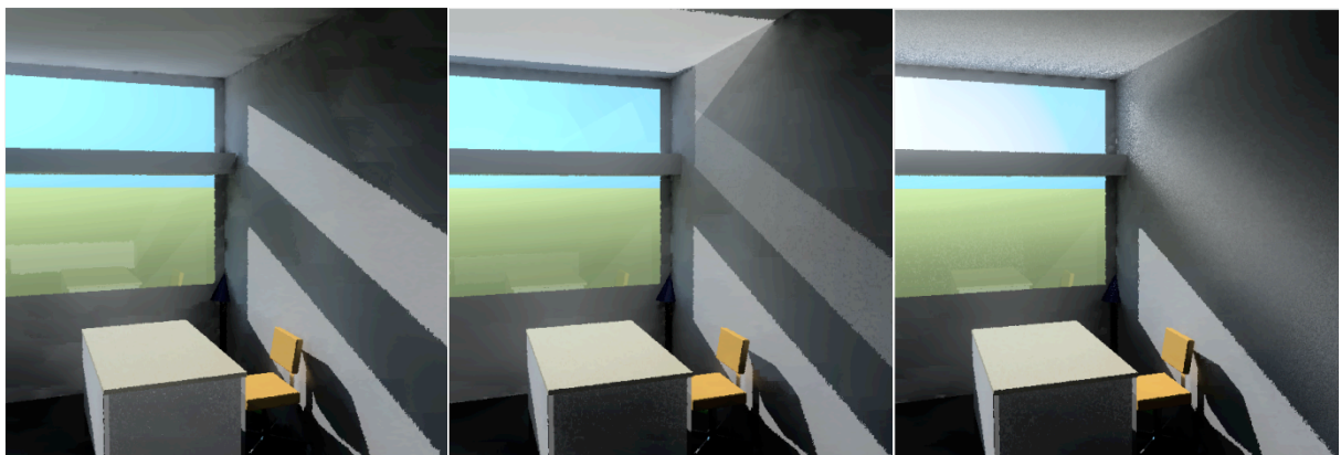
Figure 5 : Visualisation d'un système complexe de fenêtres de type « Laser Cut Panel », de gauche à droite : fenêtre supérieure munie d'un double vitrage (glass), simulation par CFS prism2 et simulation par CFS mkillum.
