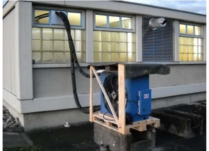
Ein Lufterhitzer mit frequenzabhängiger Motorsteuerung dient dem kontrollierten Leistungszug der Sonde
