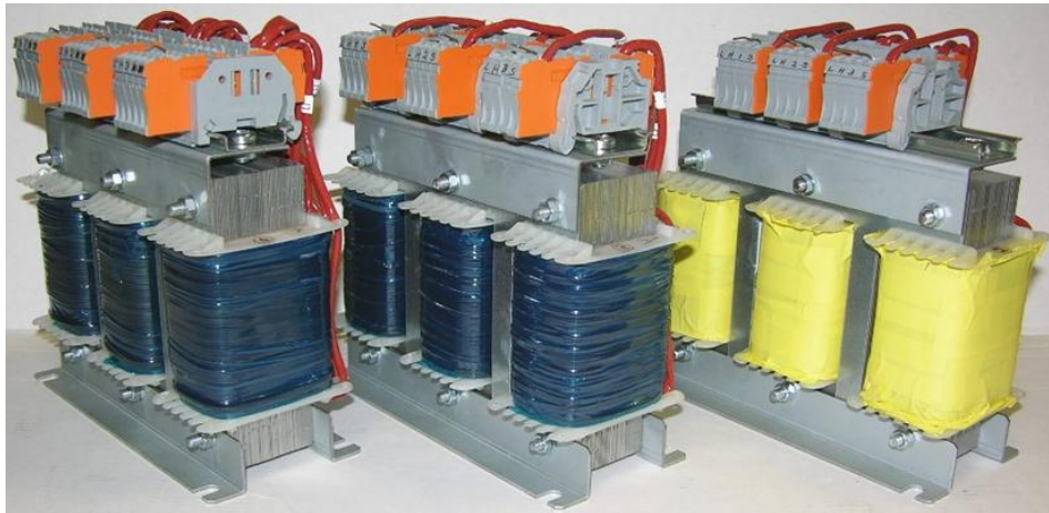
Figur 20 4kW-Prototypen (verschiedene Wicklungsvarianten) eines nicht-induktiven Strom-Splitters.
