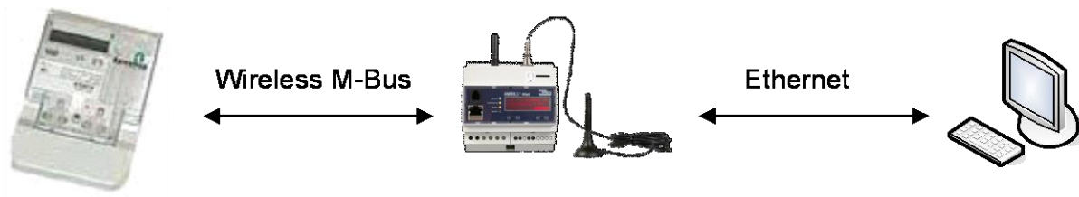
Figure 29 Topologie du système de Kamstrup
