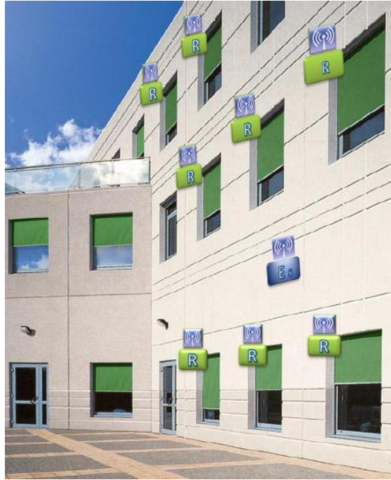
Fig. 3 La structure du système de gestion des stores à l'extérieur.
