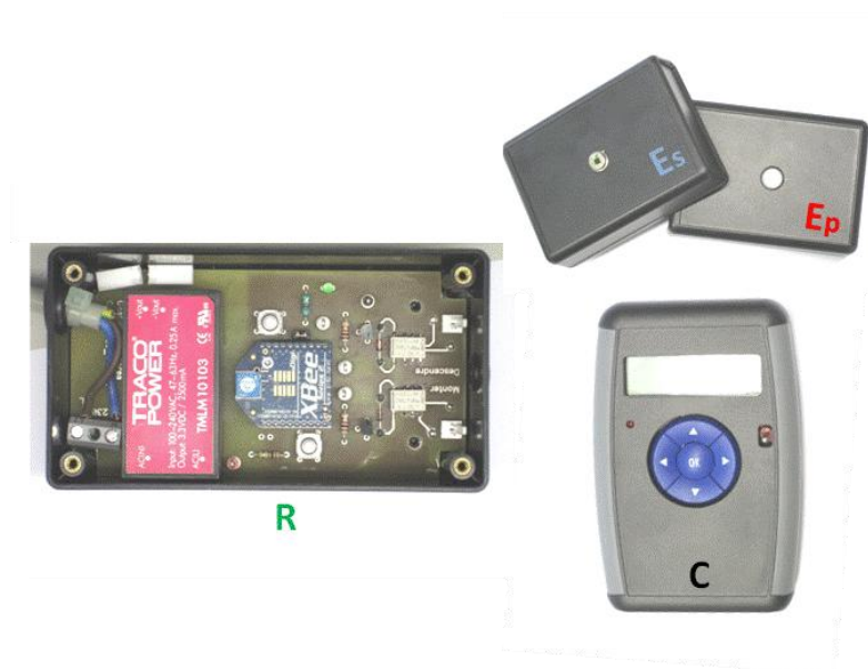
Fig. 3: Prototype 'Stand Alone' pour gestion pièce par pièce des stores électriques.
