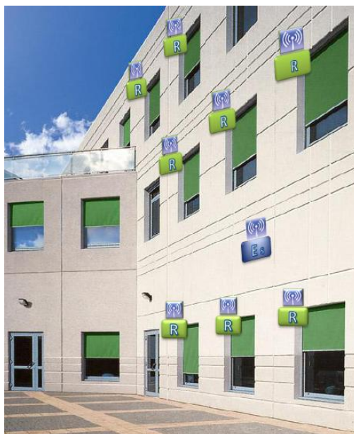
Fig. 2: La structure du système de gestion des stores à l'extérieur.
