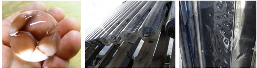
Figure 5 : Les tests de qualité des capteurs intègrent un test de grêle de plus en plus sévère vu les modifications climatiques (SPF).
