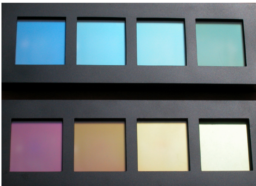
Figure 1 : échantillons de verre solaire de couleur réalisés au Leso EPFL.
