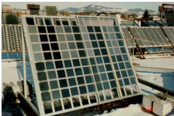
Figure 2 : 20 années d'exposition d'échantillons de couverture transparentes pour capteurs solaires à Rapperswil (à gauche) et à Davos (à droite) avec une inclinaison fixe de 60° sur l'horizontal. (photos : SPF)
