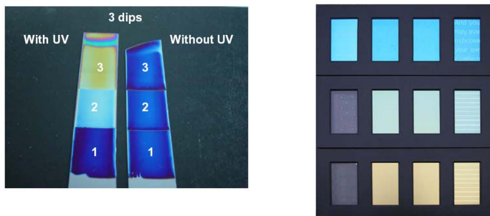
Figure 3 : durcissement par UV des couches minces déposées sur du verre pour les stabiliser (image de gauche) et coloris obtenus pour diverses combinaisons de couches (image de droite) [5].
