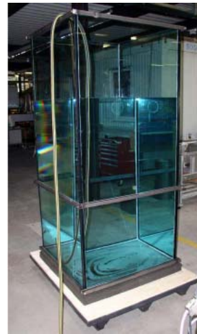
Figure 1 : test de systèmes d'eau chaude sanitaire à thermosiphon mais à tubes sous vide au SPF et installation d'une cuve de stockage en verre pour étudier les mouvements thermiques internes (doc. SPF)
