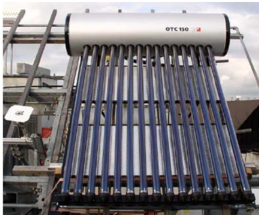
Figure 1 : test de systèmes d'eau chaude sanitaire à thermosiphon mais à tubes sous vide au SPF et installation d'une cuve de stockage en verre pour étudier les mouvements thermiques internes (doc. SPF)
