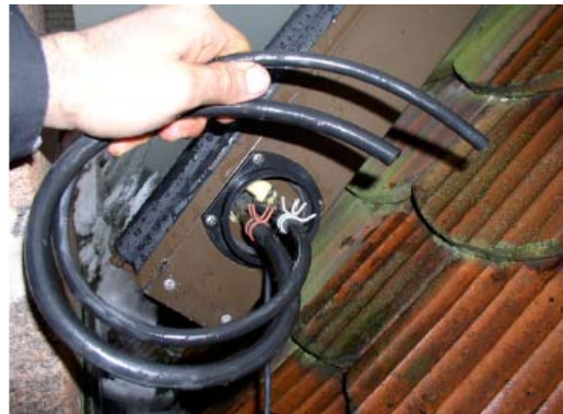
Figure 14: Elastomer - Flextube nach 2 Betriebsjahren:
