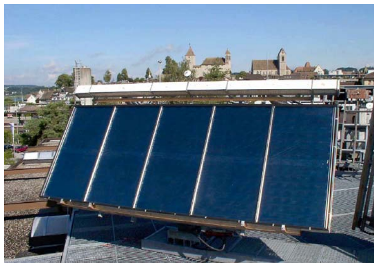
Figure 2 : nouveau banc test de capteurs permettant de tester un ensemble de 12,5 m 2 , développé par le SPF
