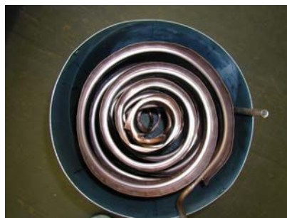
Figure 7 : Le module contenant le matériel de stockage et l'échangeur « solaire-stock » en spirale
