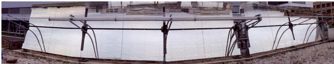
Figure 5 : le concentrateur extra-plat CEP de près de 10 mètres du projet SPS peut atteindre une efficacité de 50%
