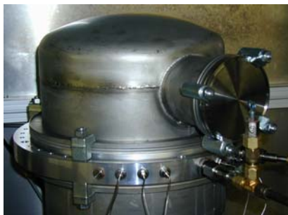
Figure 7 : Le module contenant le matériel de stockage et l'échangeur « solaire-stock » en spirale
