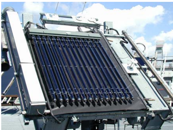
Figure 2 : test du capteur à tubes sous vide d'un type nouveau développé par le SPF
