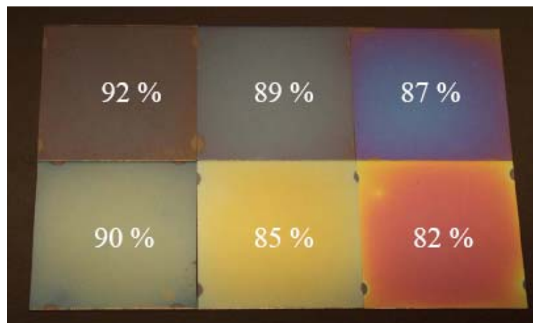
Figure 3 : Echantillons de verre solaire colorés en couches minces interférentes par le procédé SolGel
