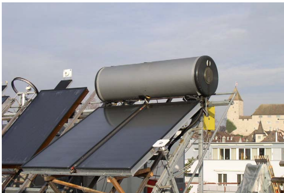
Développement et test de chauffe-eau solaire à thermosiphon au SPF Rapperswil
