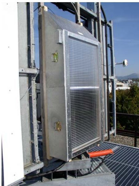
Figure 2 : nouveau banc test de façade solaire verticale, développé par le SPF dans le cadre de SOLABS
