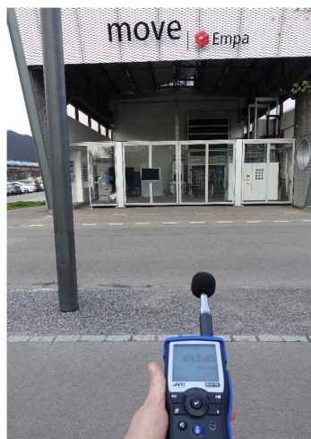
Abb. 1 Messung des Schalldruckpegels im Anlagenbetrieb (Bild: Prose AG)
