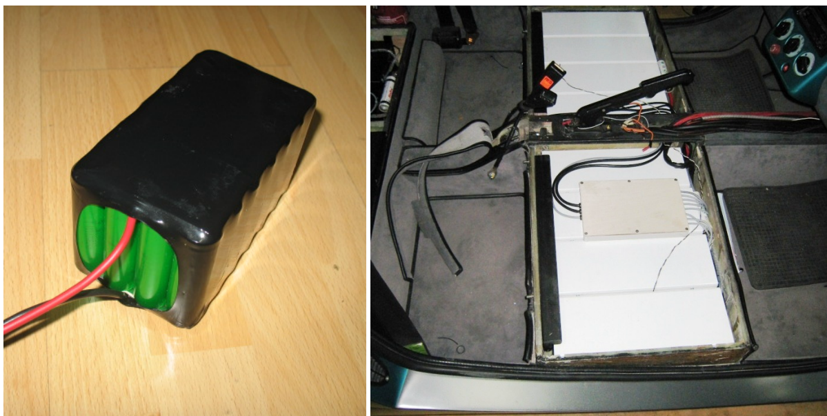
Abbildung 2: Die neuen Zellen als kleiner Block und als System unter den Frontsitzen
