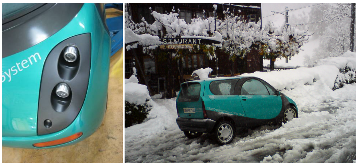
Abbildung 3: Die neuen Frontleuchten des H301 und das Fahrzeug auf einer Testfahrt im tief verschneiten Lauterbrunnen
