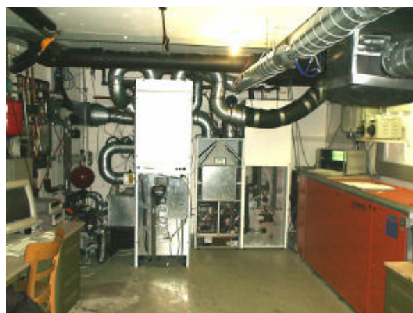
Abb. 2-39: Teststand des Fraunhofer ISE für Lüftungs-Kompaktgeräte im Keller des Solarhaus Freiburg.
