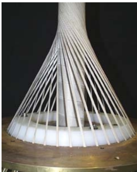
Abb. 3: Statischer Verseilkopf mit den 40 Bi-2223 Bändern einer Lage während der Verseiloperation
