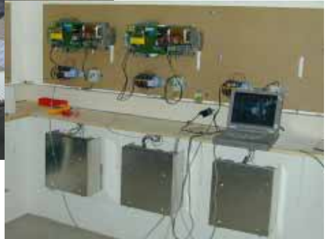
Bild 3 oben: Ausschnitt der 250 kWp Anlage mit LON Wechselrichtern, rechts: Prototypen im Labor Fotos: NET AG
