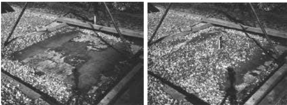
Bild 5. Um die Stabilität der Prototypen zu testen wurde ein entsprechender Laboraufbau erstellt, der Ausreissversuche in vertikaler Richtung bis zu einer Zuglast von 100 kg zulässt.
