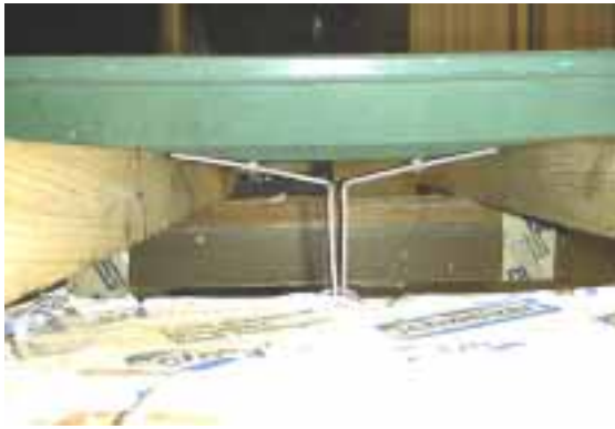
Bild 21: Detailansicht bei Belastung von 240 kg
