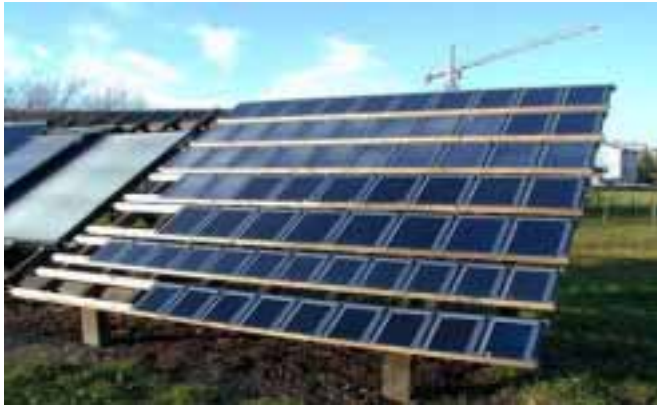
Abb. 3: Freibewitterungsstand am Institut für Solartechnik SPF, Hochschule Rapperswil HSR.
