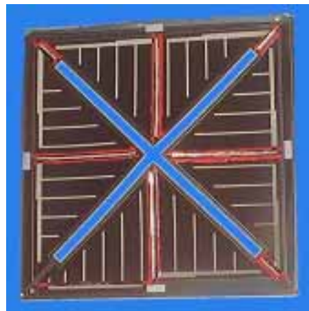
Figure 3 : Module composé de 8 cellules connectées en série. Une croix a été découpée par laser afin de permettre à l'antenne, sur laquelle ces modules ont été collés, d'irradier. La structuration du module a été réalisée par laser.
