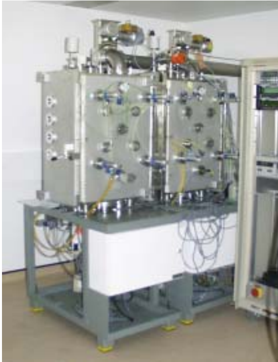
Bild 1: Einkammer 30x30 cm 2 VHF Plasma Depositionsanlage am IMT (Projekt DOIT, Bildquelle IMT / Uni NE)
