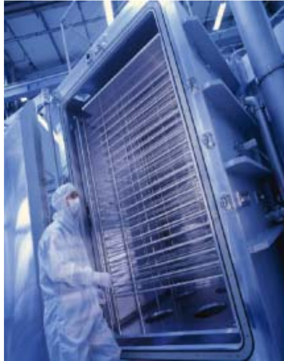
Bild 2: Industrielle Plasma Depositionsanlage (Bildquelle Unaxis)
