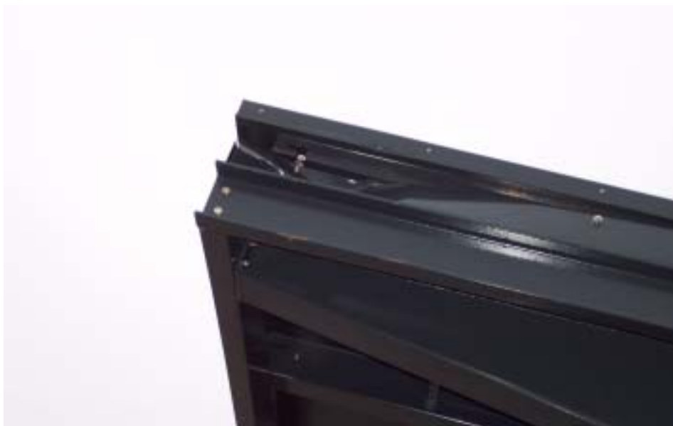
Fig. 1: Impact sur le bord du module supérieur.
