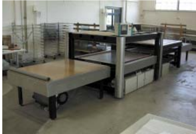
Abb. 6 3S Laminierstrasse mit Einfahrtisch, Laminator und Kühlpresse
