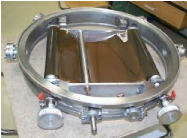
Fig. 7 Roll-to Roll Ätzeinheit mit Linearelektrode
