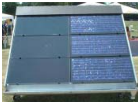
Abb. 2 Dachmodell mit amorphen und polykristallinen Zellen
