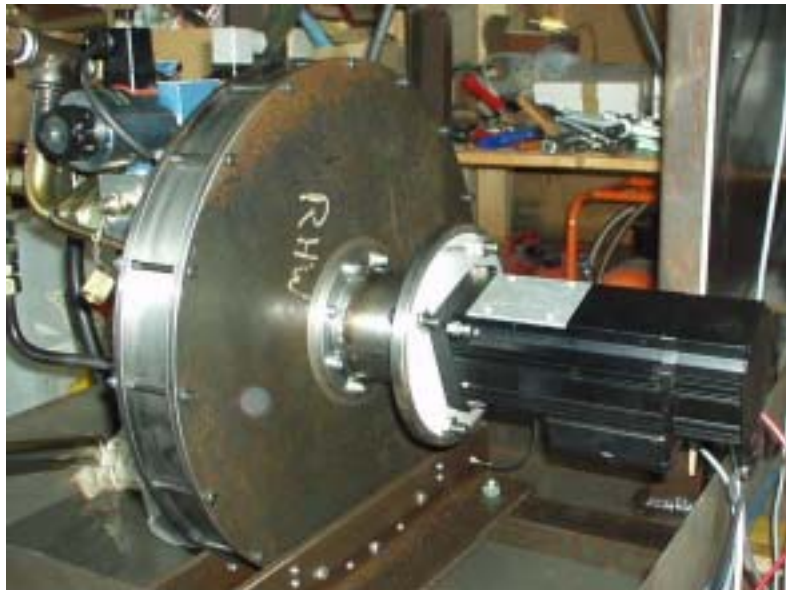
Photo 2 : ensemble générateur depuis air comprimé sur banc d'essai, détails du volant d'inertie et de la génératrice électrique.
