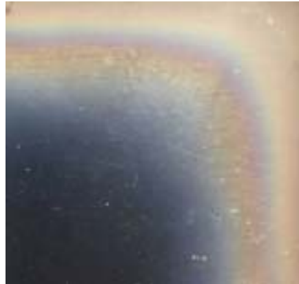
Fig. 1 : Plasma behandeltes Polyimid Substrat das mit Al beschichtet wurde
