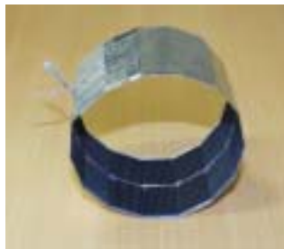
Abb. 3: Hochflexibles TPV Photozellenmodul von Solaronix.
