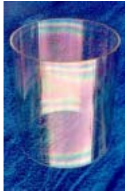
Abb. 2: IR reflektierendes \text{SnO}_2 Filter von Solaronix, das auf der Innenseite eines Quarzzylinders abgeschieden wurde.
