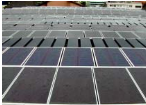
Bild 12: 18 Testanlagen mit Dünnschichtzellen im direkten Vergleich (Bildquelle: NET AG)
