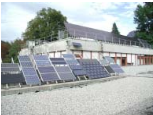
Bild 5: TISO PV Modulteststand (Bildquelle LEEE TISO)
