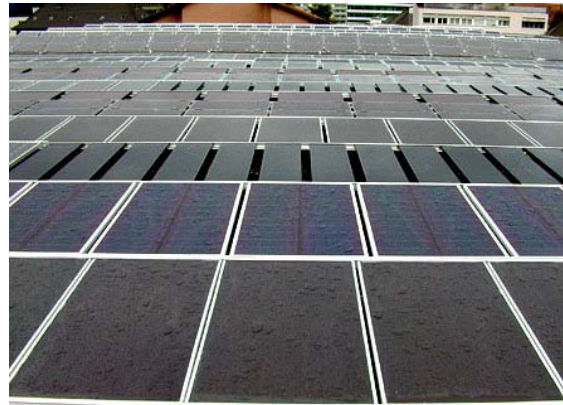
Bild 12: 18 Testanlagen mit Dünnschichtzellen im direkten Vergleich (Bildquelle: NET AG)
