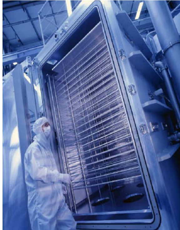
Bild 2: Industrielle Plasma Depositionsanlage (Bildquelle Unaxis)
