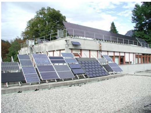
Bild 5: TISO PV Modulteststand (Bildquelle LEEE TISO)
