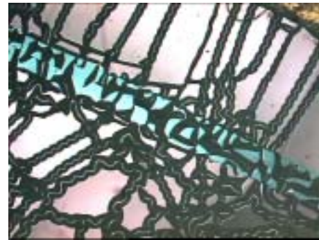
Figur 6: Mikroskopische Aufnahme einer Fläche von 3mm x 2mm in einem Bereich mit starken Ablösungserscheinungen
