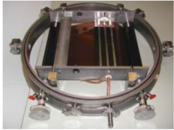
Figur 3: Roll-to Roll-Einsatz mit flächiger Ätzelektrode, Untenansicht, mit 3 HF-Stäben (Konfiguration C) und eingespanntem Polyimidfilm
