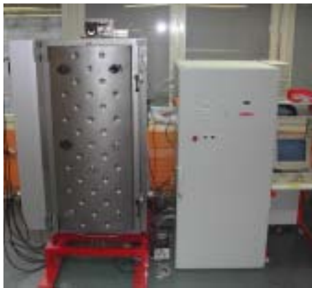
Figure 3: Machine de pulvérisation cathodique (PVD) fonctionnant en continu (roll-to-roll)
