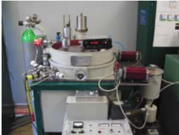
Figur 2: A550 VKZ Leybold RIE Aetz-Anlage des EIAJ, vorne: HF-Sender, rechts: Schrittmotoren.
