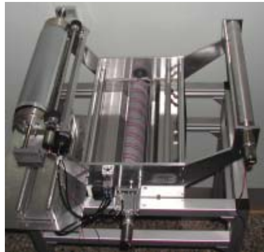
Figure 8: Machine lift-off automatique: à gauche, rouleau du film à traiter; centre: cuve de lavage avec brosse rotative; droite: rouleau récepteur.
