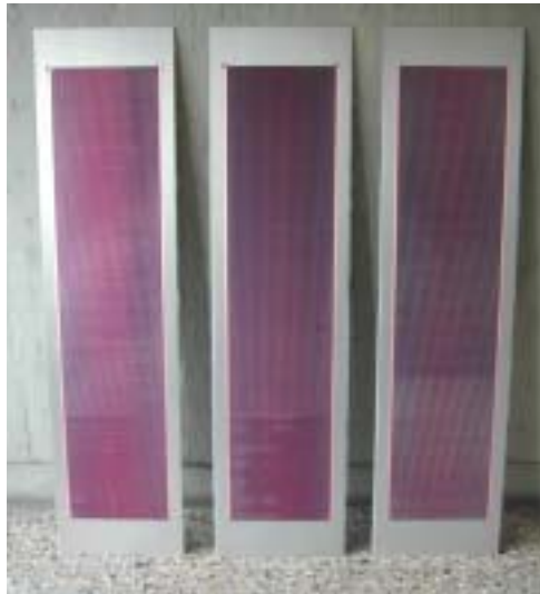
Figur 7: Module auf 3mm Aluminiumfassadenblech, Grösse 1400mm x 350mm, aktive Fläche 1200mm x 280mm, Leistung 7W_{peak}
