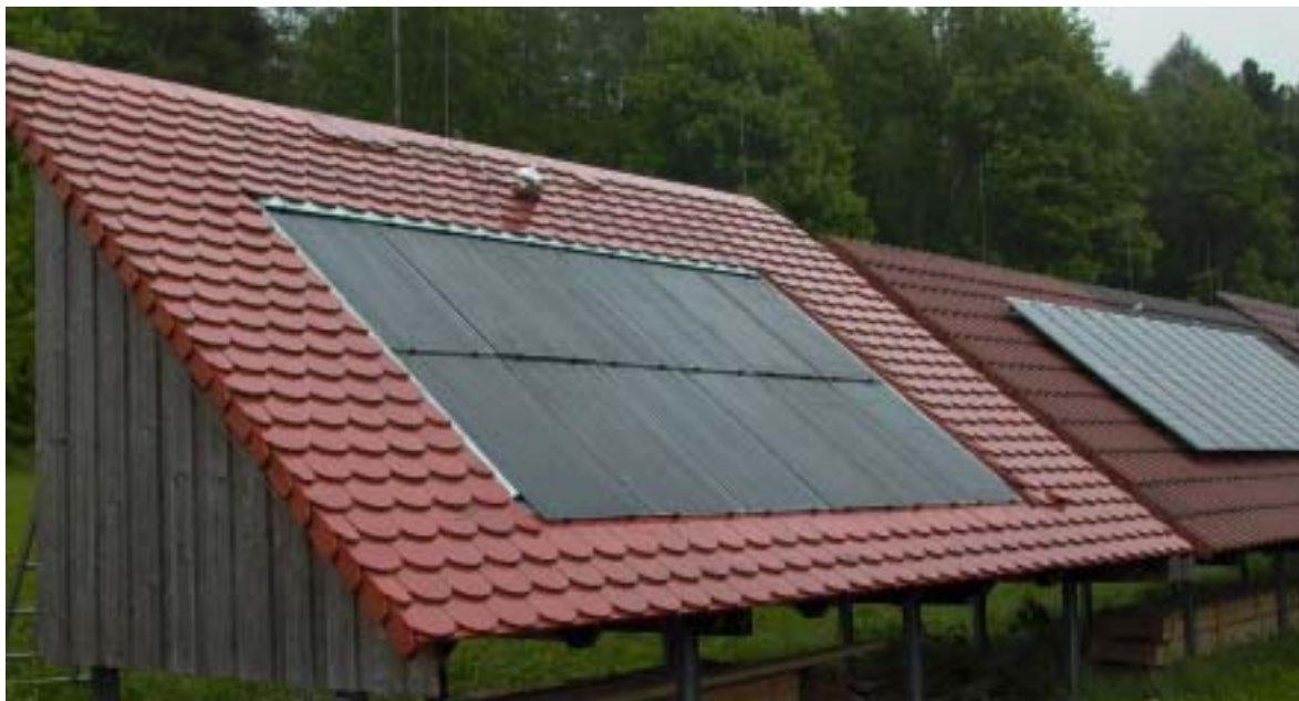
Abb. 3 Freiluftdemonstrator mit CIS-Elementen
