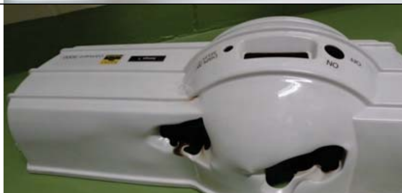
Fig. 4: Durchgeschmolzenes Gehäuse des vom Brand betroffenen Wechselrichters Convert 4000.
