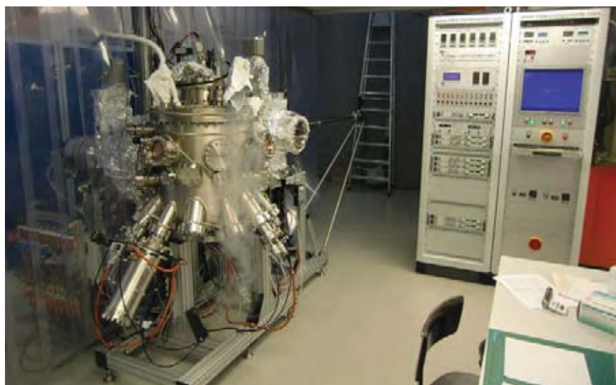
Figur 3: Neue Molekularstrahlepitaxie-Anlage zur Abscheidung von CIGS-Absorberschichten. Es können CIGS-Schichten in mehrstufigen Prozessen auf Substraten bis 10 \times 10 \text{ cm}^2 deponiert werden (Bild Empa).
