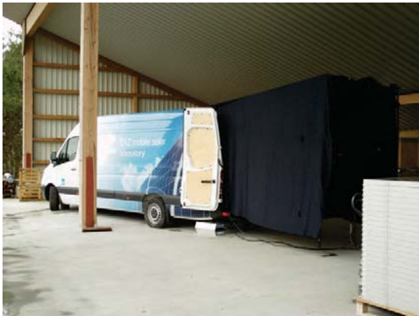
Abb. 1 Seitenansicht Mobiles Messlabor (Swiss Mobile Flasher Bus) beim Einsatz auf einem Bauernhof in Süddeutschland
