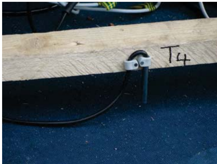
ABBILDUNG 12 TEMPERATURMESSUNG IM UNTERDACH
