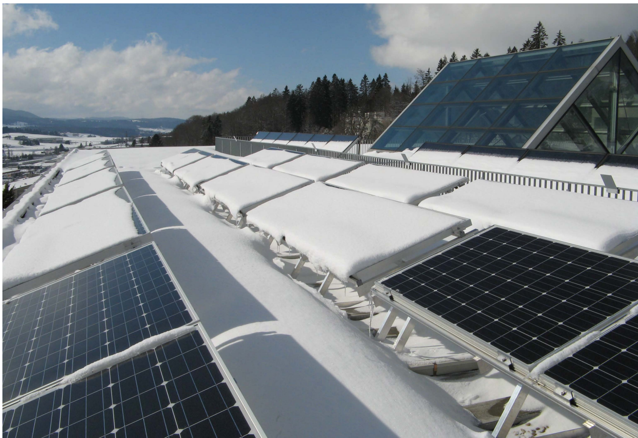
Figur 4: Zustand von schneebedeckten PV-Modulen an einem Februar-Tag mit unterschiedlichen Lösungen zur Schneee Entfernung (von vorne: Eulekra, Freso, Solutronic (X2) und Bosch als Referenz) (Bildquelle: Planair).
