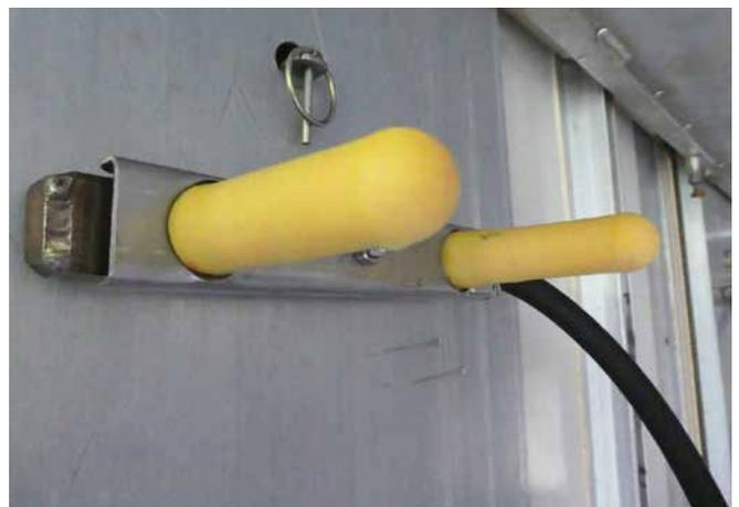
Abbildung 3 und 4: Neues Tränkesystem in Form eines Nuckels zur Wasserversorgung von Kälbern auf einem Transportfahrzeug. Da Kälber in der Regel zwei bzw. dreistöckig transportiert werden, muss das Schlauch- und Nuckelsystem abgenommen und bei endgültiger Position der Hubböden wieder installiert werden (Fotos: LAVES, Tierschutzdienst).
