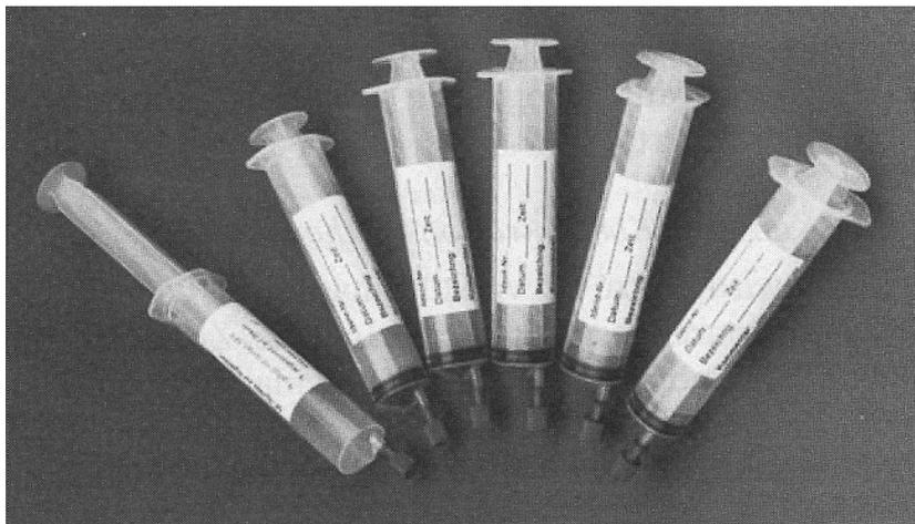
Figur 3.6 Das Spritzenet für die Luftproben und das Injektorgas
