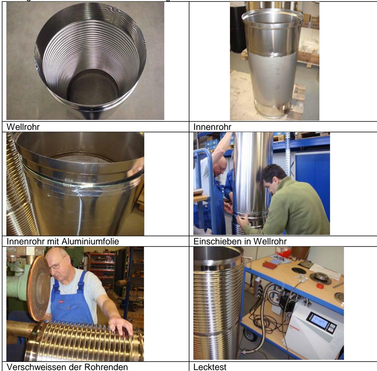
Fig. 17 Fertigung eines Vakuumrohrs
