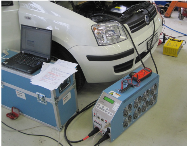
Abbildung 18: Bestimmung der Restkapazität einer Fahrzeugbatterie mit der elektronischen Last im Vordergrund
