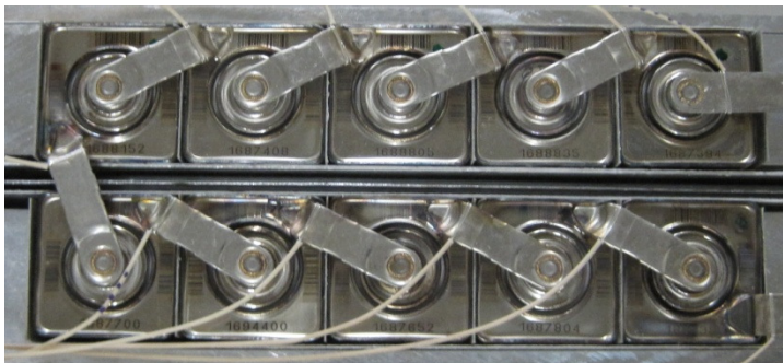
Abbildung 3: Zehn in Serie geschaltete ZEBRA-Zellen mit Potentialabgriffen
