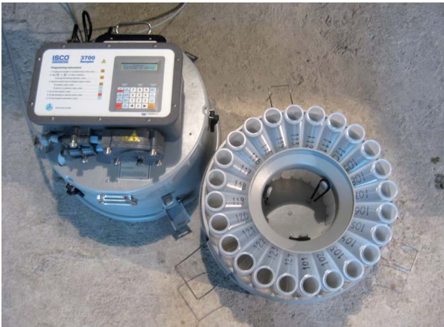
Bild 2. Programmierbarer Wasserprobennehmer, im Bild mit abgehobenem Deckel, mit Pumpe und Vorrichtung zum Füllen von bis zu 24 Flaschen (Foto: VAW).
