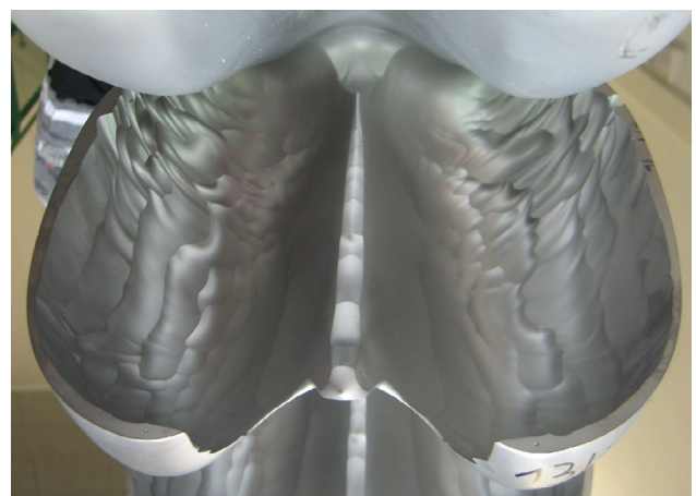
Abb. 2 Beispiel eines Pelton-Laufrads, das durch feine Gesteinspartikel im Triebwasser stark abgenutzt wurde. Es sind die Verbreiterung der Mittelschneide und Abrasion in den Bechern zu erkennen (Bild: TIWAG).
