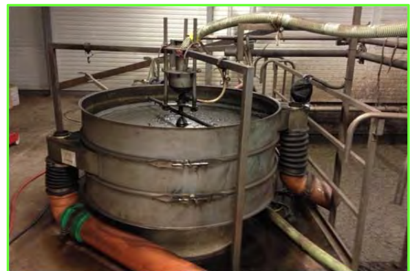
Abb. 2.6: Rotamaten mit Dosierbehälter für Flockungsmittel (links) und Rüttelsieb (rechts)
