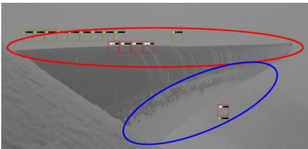
Abb. 39: Rot: Vorderkante des Flügels ist nach Einsatz der Blattheizung eisfrei. Blau: Eis bleibt im hinteren Teil des Flügels bestehen.
