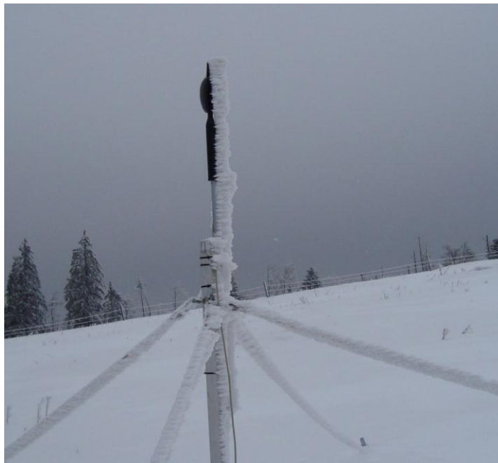
Abb. 71: Eisansatz an der Schallmessung in St. Brais.
