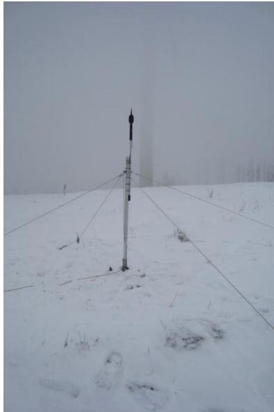
Abb. 67: Links: Installierte Schallmessung mit WEA 1 im Hintergrund. Rechts: Zeitlicher Verlauf des Schallpegels.
