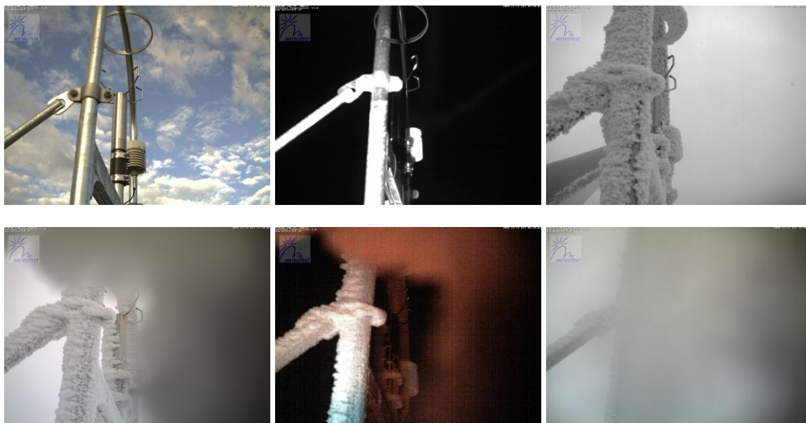
Abb. 12: Oben: Bilder der Sensorkamera tagsüber (links), bei Nacht (Mitte) und während eines Vereisungsereignisses (rechts). Unten: Beeinträchtigte Sicht auf die Sensorik wegen vereister Kamera.
