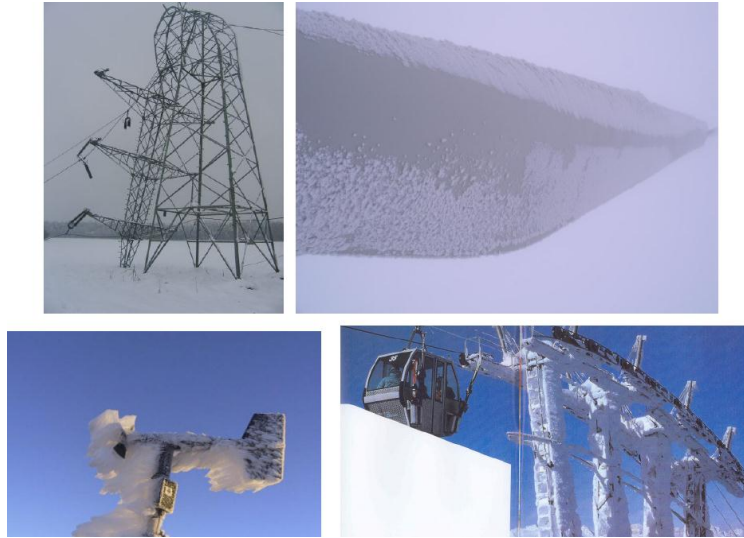
Abb. 15: Die Vereisung an Strukturen betrifft viele Bereiche. Oben links: Wegen Vereisung eingestürzter Mast einer Hochspannungsleitung. Oben rechts: Vereisung am Rotorblatt einer WEA. Unter links: Vereistes Propelleranemometer. Unter rechts: Vereisung am Mast einer Seilbahn.
