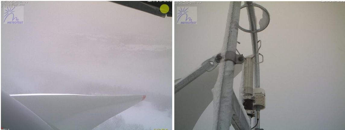
Abb. 52: Links: Eisansatz am Rotorblatt während des von der Eisdetektion nicht erkannten Ereignisses Ende November/Anfang Dezember 2010. Rechts: Eisansatz an der Sensorik der WEA. Die Bilder datieren vom 30. November 2009, 10:54 (links) und 10:50 (rechts).
