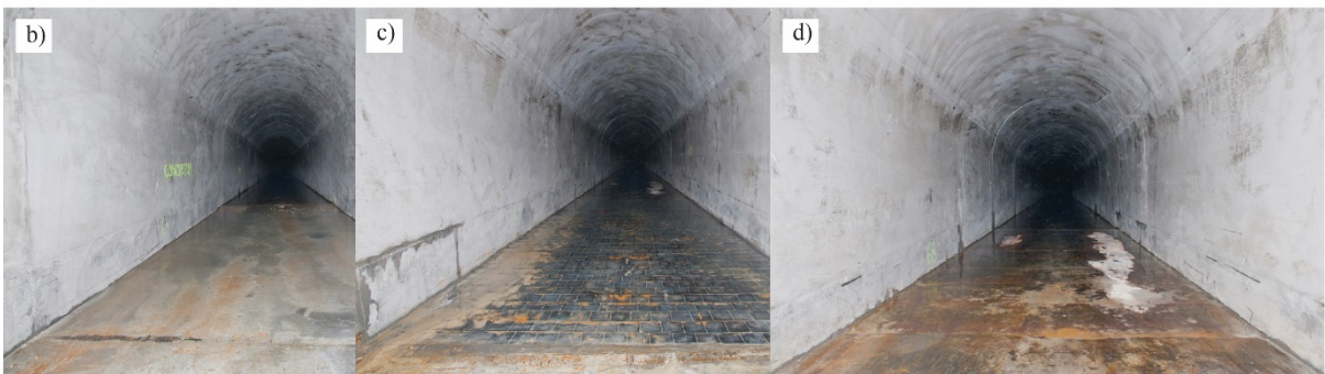
Abbildung 6: a) Schematische Darstellung der im SBT Solis eingebauten Testfelder, b) C50/60 mit 3 kg/m 3 HMPF und Schwindreduktionsmittel, c) Schmelzbasaltplatten, d) Stahlpanzerung mit selbstverdichtendem Beton verfüllt (VAW, ETH Zürich)
