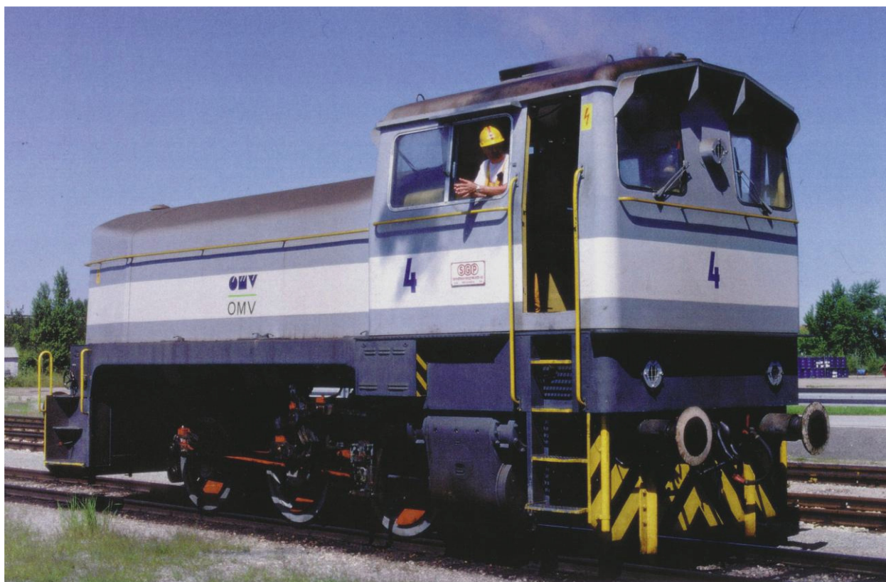
Bild 17: Moderne Hochdruck-Dampfspeicherlokomotive des Typs C 60.85 mit 85 bar Ladedruck und Überhitzung. Vier baugleiche Lokomotiven wurden von 1961 bis 1973 gebaut. Die DLM AG verfügt über einen vollständigen Satz von Fabrikationszeichnungen dieser Lokomotive. Foto: Roger Waller
