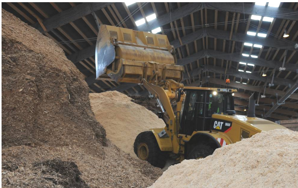
Bild 32: Pneulader für den werksinternen Verkehr. Solche das Werkareal nie verlassenden, grossen Arbeitsgeräte sind prädestiniert für die Speichertechnik, zumal sie an Ort und Stelle mit Abfalldampf aus der Kraft-Wärme-Koppelung aufgeladen werden können. Bild aus dem Internet
