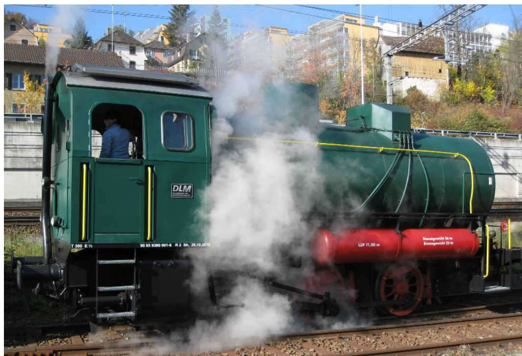
Bild 48: Anlässlich der Revision bei der DLM wurden bereits einige Verbesserungen ausgeführt. Für die Stromversorgung wurden zwei Solarpaneele auf das Führerhausdach montiert, die zusätzlich durch Schattenbildung das Raumklima im Führerstand verbessern. Neue Rangiertritte sorgen für bessere Sicherheit. Foto: Roger Waller
