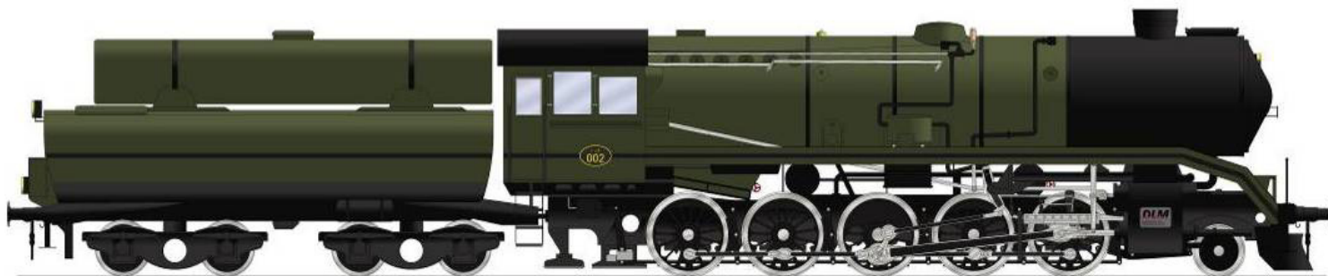
Bild 54: Typenskizze einer von der Firma DLM für den Güterverkehr konzipierten, modernen Dampflokomotive. Dieses Konzept eignet sich sowohl für klassische, gefeuerte Dampflokomotiven als auch für Speicherbetrieb. Bei der Ausführung als Speicherlokomotive würde der Schlepptender als zusätzlicher Heisswasserspeicher ausgeführt. Speichervolumen von bis zu 100 m 3 sind möglich. Zeichnungen: DLM AG
