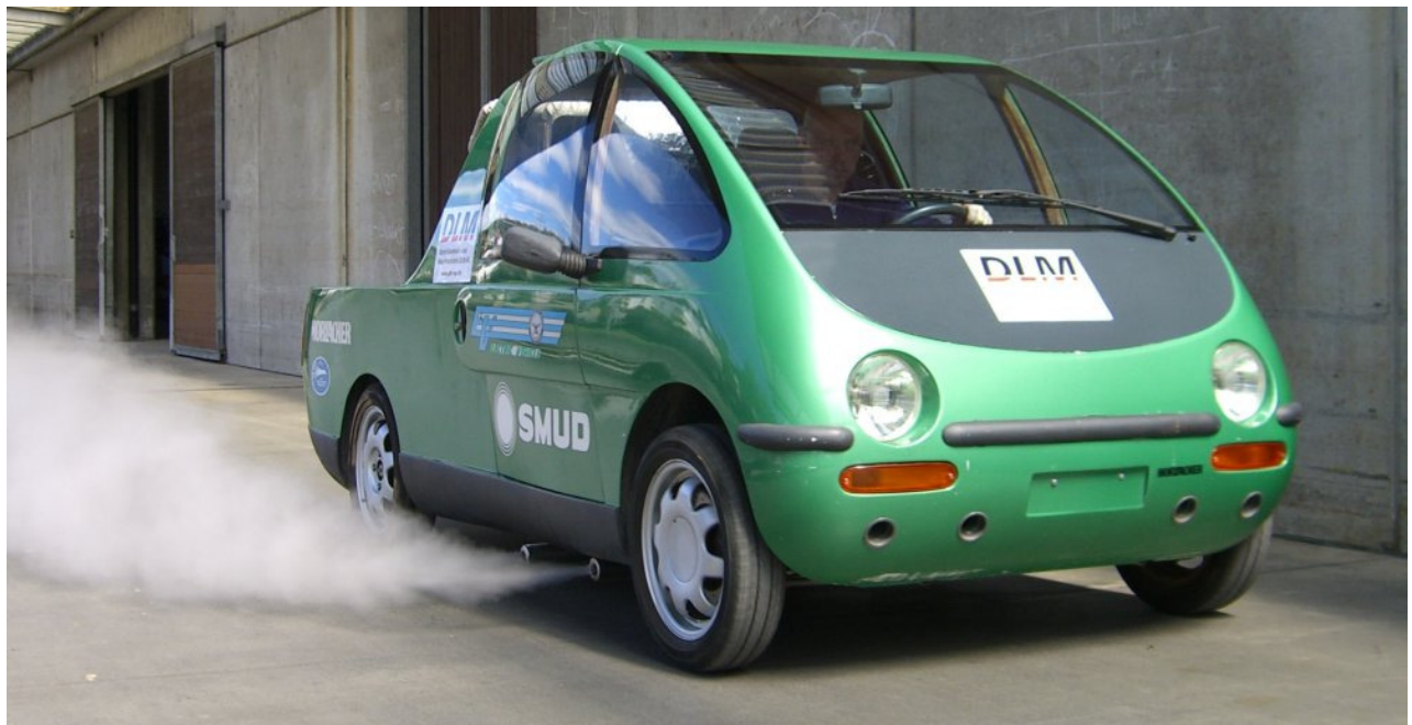
Bild 18: Demo-Mobil II: Dampfmaschinen bringen ihr maximales Drehmoment aus dem Stand heraus und benötigen weder Kupplung noch Getriebe. Rückwärts könnte ebenso schnell gefahren werden wie vorwärts. Das Demo-Mobil II wog betriebsbereit 600 kg. Foto: Roger Waller
