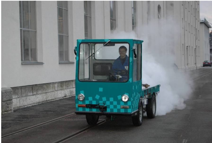
Bild 19: Demo-Mobil III: Dampfmaschine und Druckbehälter sind Unterflur platziert, sodass die ganze Ladefläche genutzt werden kann. Sollte der aus reinem Wasserdampf bestehende Abdampf stören, könnte er kondensiert werden. Foto: Roger Waller
