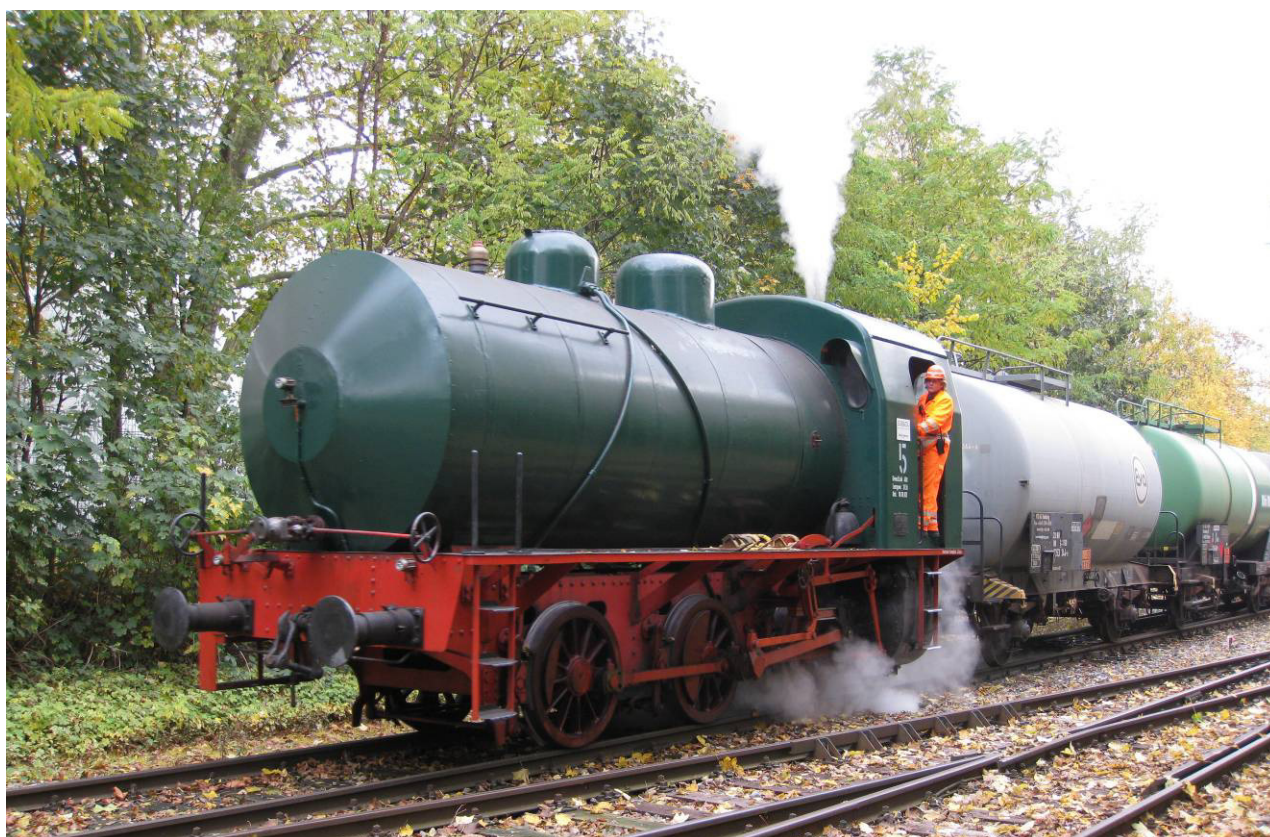
Bild 56: Trotz ihres Baujahres von 1958 erfüllt diese Speicherlokomotive bei der Firma Sasol in Herne täglich zuverlässiger, kostengünstiger und umweltfreundlicher als die Diesellokomotive ihre Aufgabe. Die Speicherlokomotive wird der Diesellokomotive immer vorgezogen. Foto: Roger Waller
