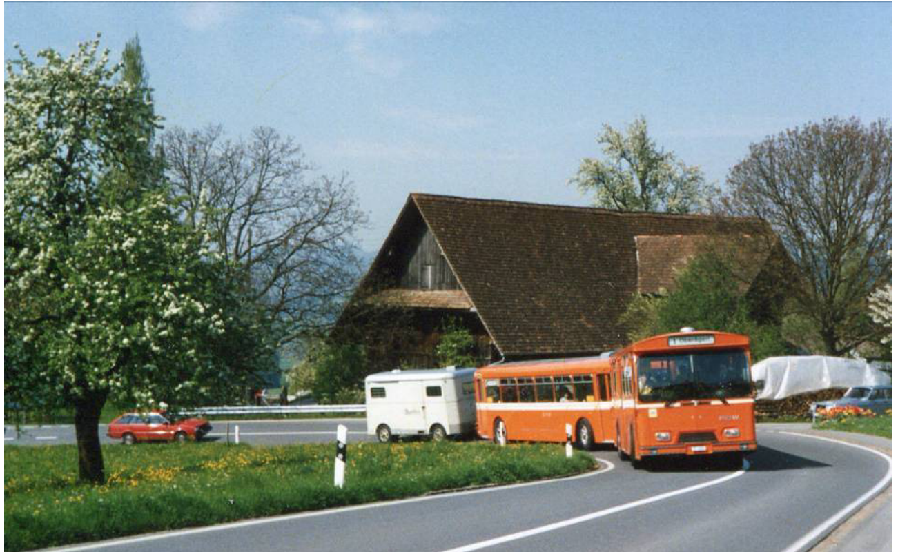
Bild 24: So ähnlich könnte ein speicherbetriebener Bus aussehen: Gelenkbus mit direkt gekoppeltem Energieanhänger. Foto: Guido Nussbaumer, Mai 1989
