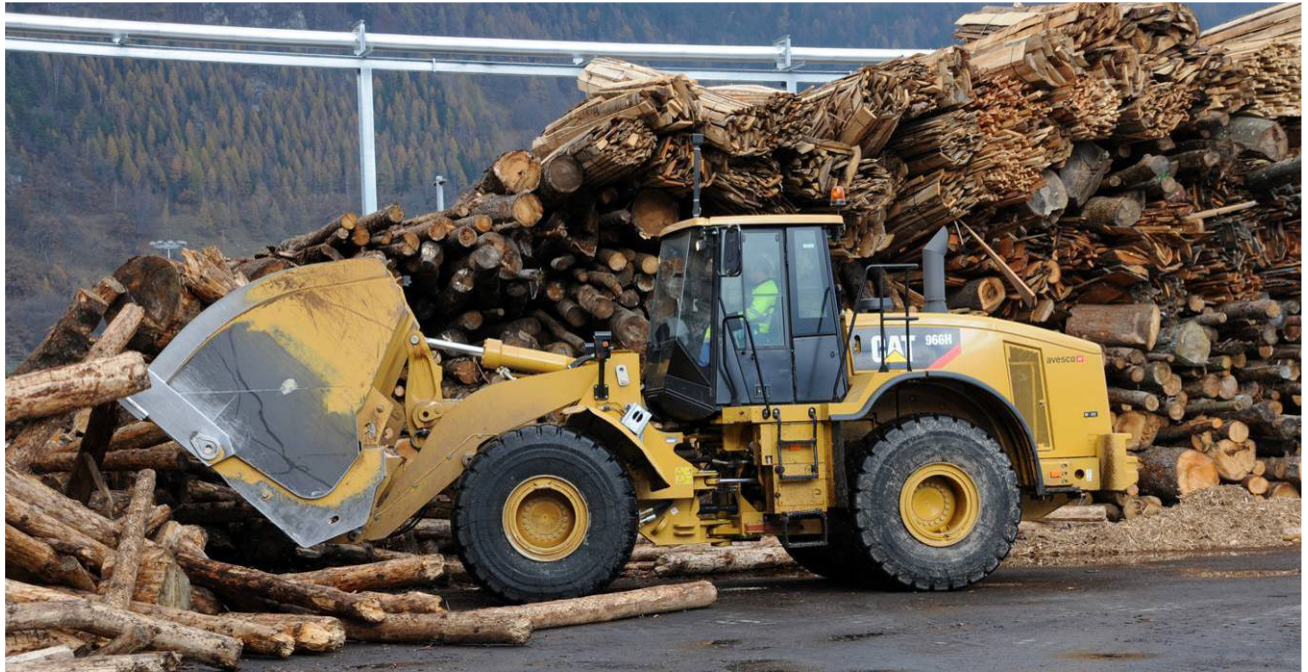
Bild 32: Pneulader für den werksinternen Verkehr. Solche das Werkareal nie verlassenden, grossen Arbeitsgeräte sind prädestiniert für die Speichertechnik, zumal sie an Ort und Stelle mit Abfalldampf aus der Kraft-Wärme-Koppelung aufgeladen werden können. Bild aus dem Internet
