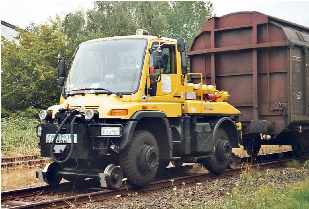
Bild 4: Typisches Zweiwegefahrzeug (Unimog U 400) für den leichten Rangierdienst. Der Abstand der Pneuräder muss in etwa der Spurweite der Bahn entsprechen. Die Spurführung auf der Schiene erfolgt durch je eine vordere und hintere Laufachse. Für den Bahnbetrieb werden die Laufachsen auf das Gleisniveau abgesenkt wie im Bild ersichtlich, im Strassenverkehr werden die Laufachsen angehoben.
