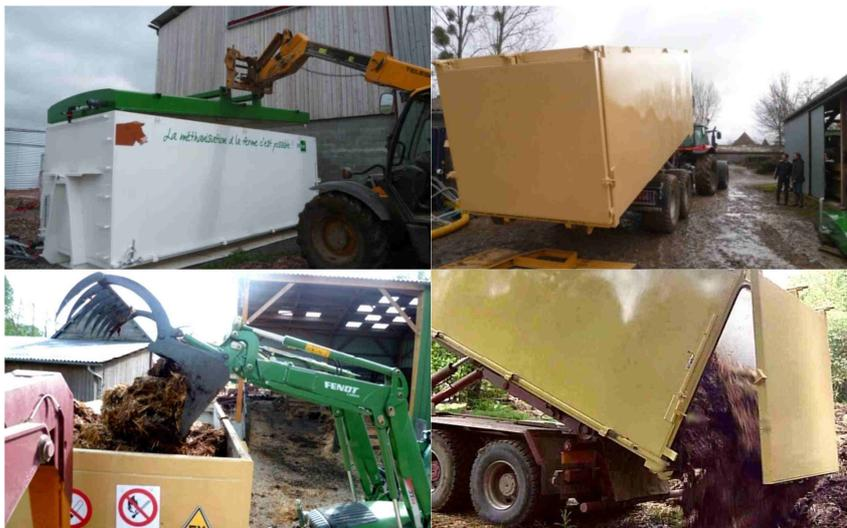
**Figure 4-16** : Photos du chargement et vidage d'un digesteur Eribox. [Source : Erigène]
