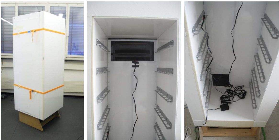
Abbildung 11: Aussenhülle des Coolers (links), Innenausbau des Freezers (mitte und rechts)
