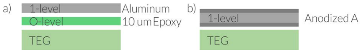
Abbildung 4: Schematische Darstellung von zwei Packaging-Verfahren für TEGs. a) das herkömmliche Verfahren in welchem der TEG mit einer 10 µm dicken Epoxy Schicht geschützt wird und Aluminium als 1-level-Packaging verklebt wird und b) das neue, verbesserte Verfahren bei welchem anodisiertes Aluminium direkt mit dem TEG verklebt wird. Das Verfahren unter b) führte zu einer Reduktion des thermischen Gesamtwiderstands des TEGs um 26%.
