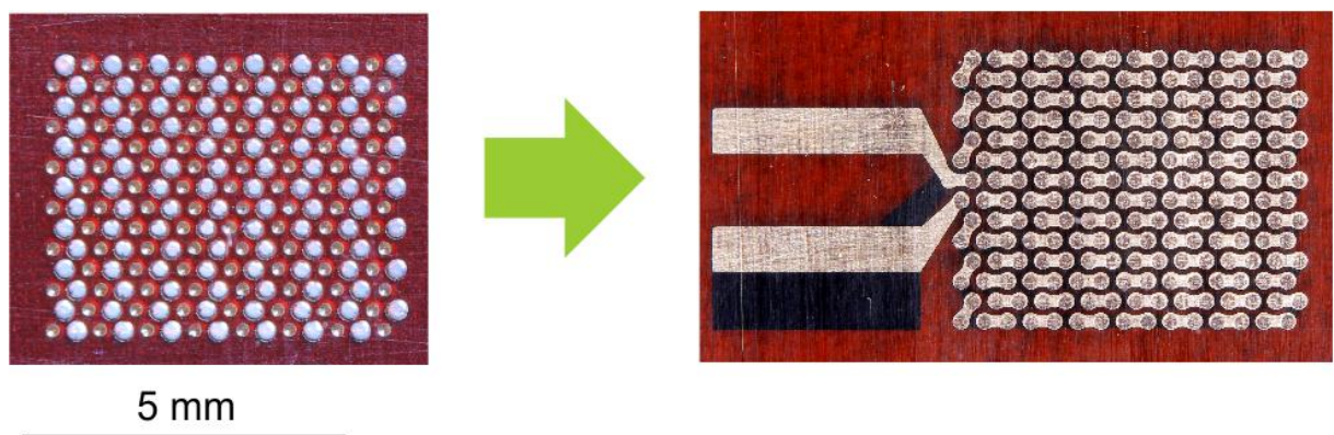
Abbildung 2: Prozessbilder eines TEGs für Energy Harvesting Anwendungen. Links ist ein Modul nach der n-Material Abscheidung zu sehen, rechts ist das fertige Modul nach der Kontaktierung (mit Maskendaten mit verbesserten Prozesskontroll-Möglichkeiten).
