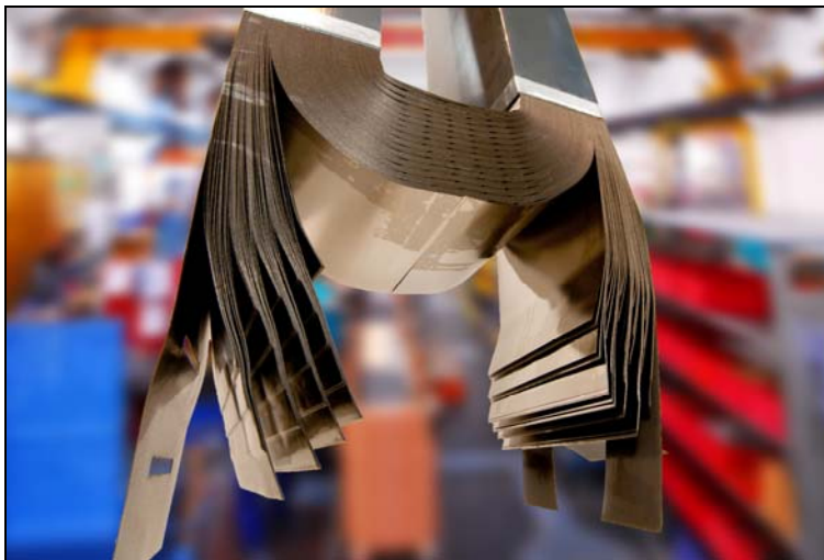
Abb 4-4: Amorphes Blech als Kernmaterial, Quelle: www.siemens.com/energy
