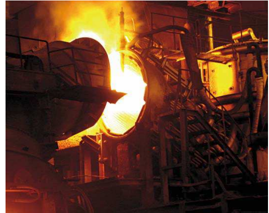
Abbildung 2 Offgas Leitung am Schmelzofen
