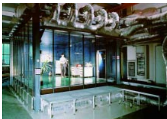
Vue de la chambre climatique (à gauche) et de l'emplacement des source et des échantillonneurs (à droite)
