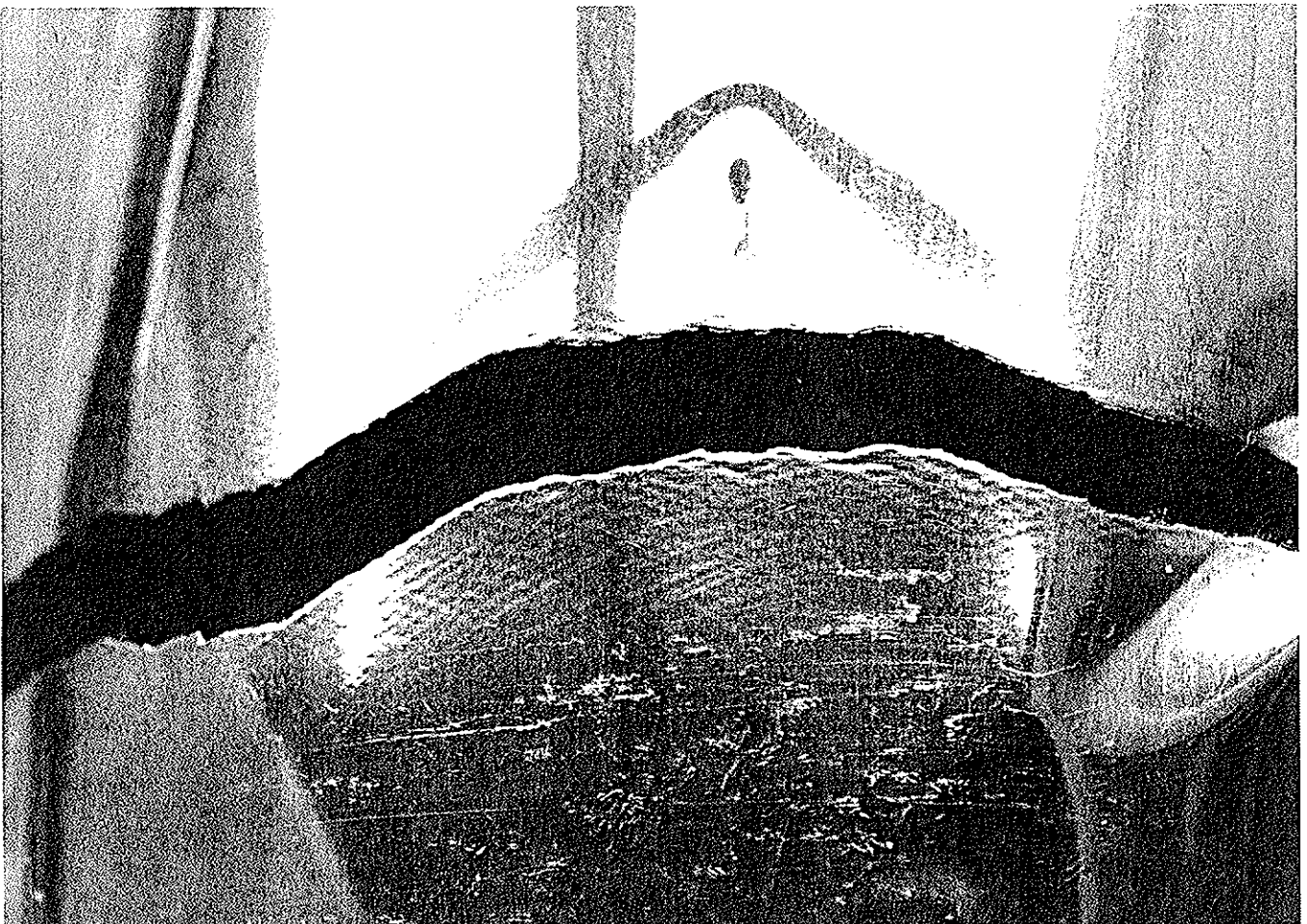
Bild 17 Riss mit Fließspuren durch plastische Deformation
