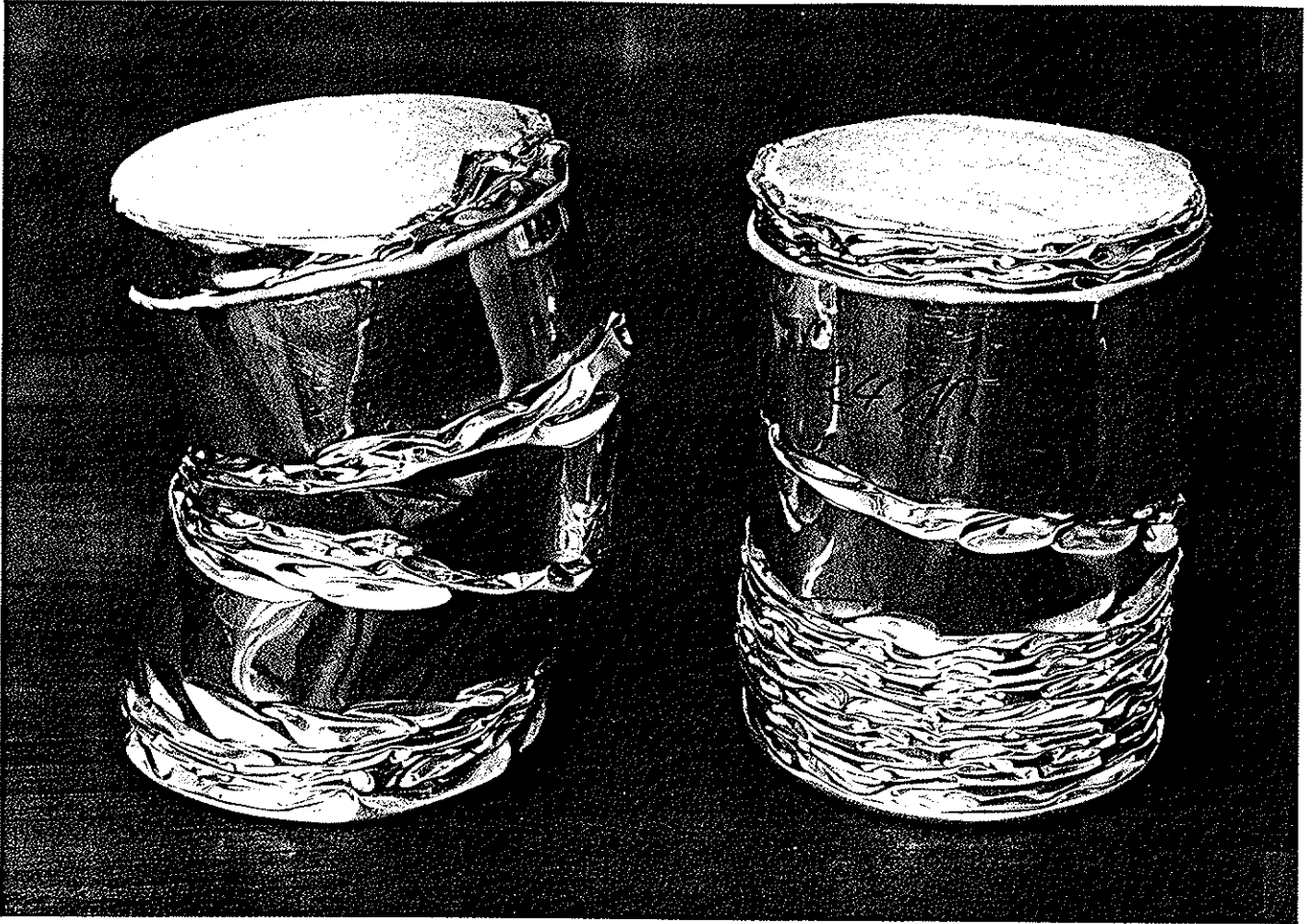
Bild 13 Axial gestauchte "Alski" Rundstangen, links mit anfänglich 15° Schrägstellung
