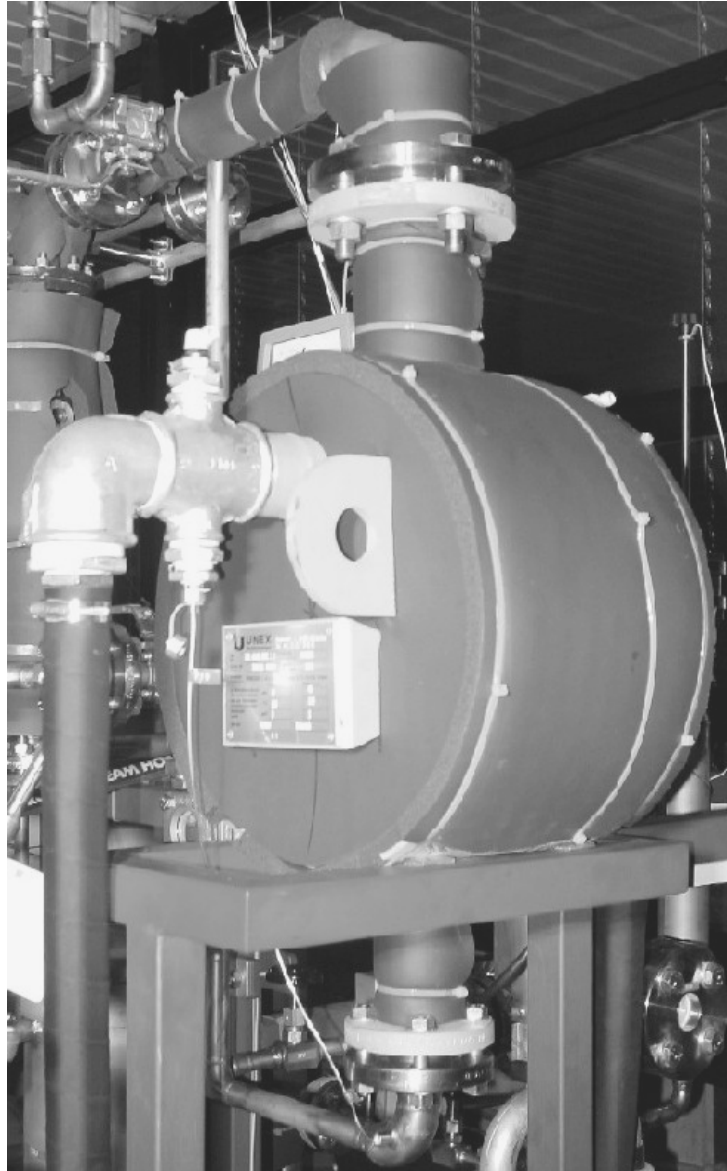
Abb. 3-9: im 4. Prototypen eingebaute Version des UNEX-Kondensators
