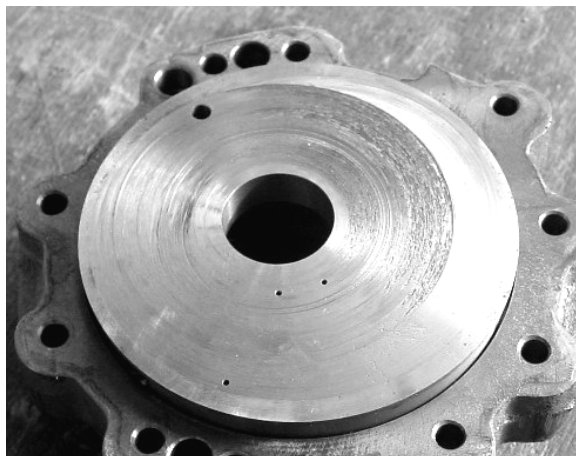
Abb. 7-1: Verdichterteile mit Schleifspuren
