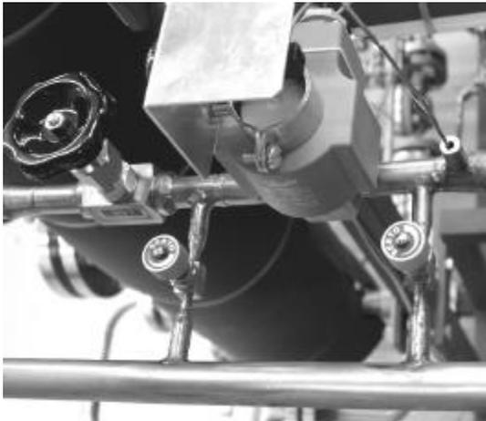
**ABBILDUNG 2: ZWISCHENDRUCK - EXPANSIONSVENTILE**
