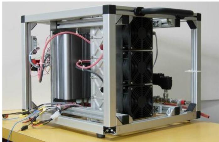
**Figure 3 : Pile à combustible 2 kW fournissant l'énergie électrique à la motorisation**
